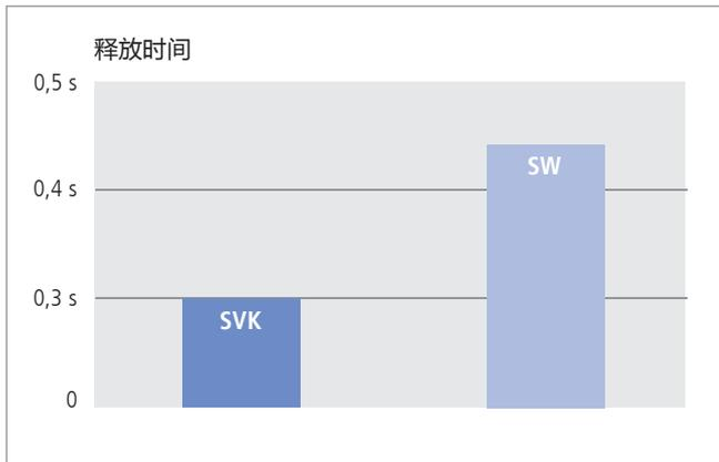
SVK 型止回阀的额定流量比 SW 节流阀型大，这使得其吹气释放用时比 SW 节流阀型用时短。(上图数据是由两款阀体同为 442mm 长度的吸具下测得)
