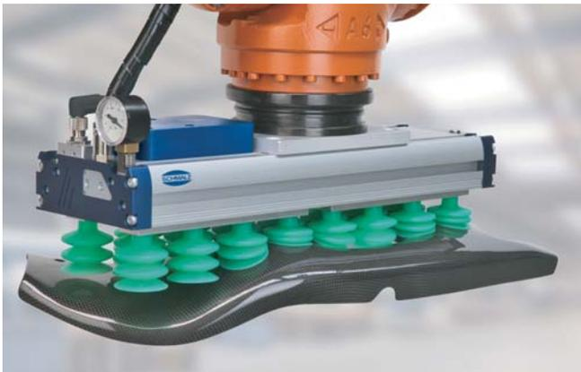
复合材料 | 大面积真空吸具系统 FXP 搬运 CFRP 模压件
