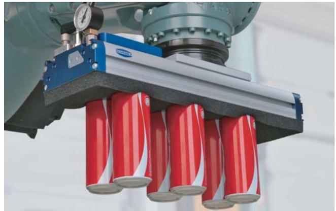
大面积真空吸具系统 FXP 搬运易拉罐
