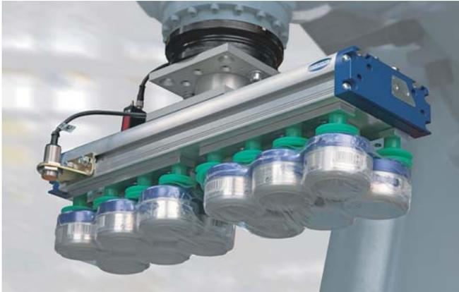
大面积真空吸具系统 FXP 搬运塑封膜包装品
