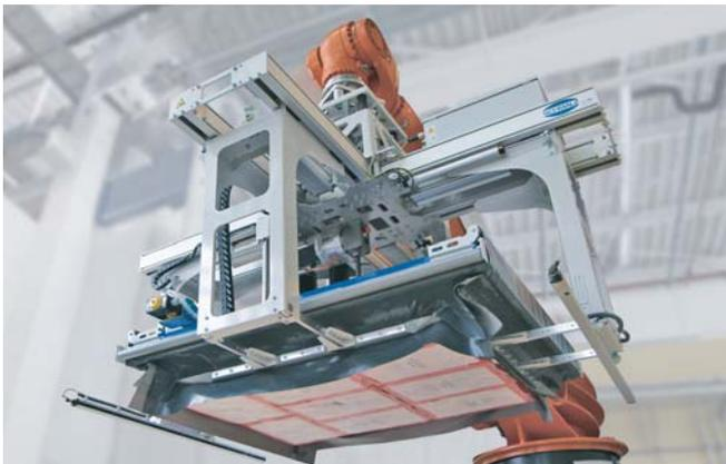
整层搬运式真空吸具系统 SPZ-M-C 对饮料托架进行码垛
