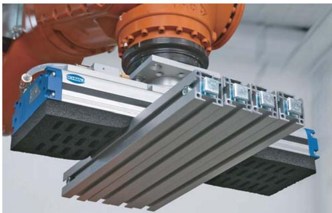
大面积真空吸具系统 FMP 对型材进行整层搬运
