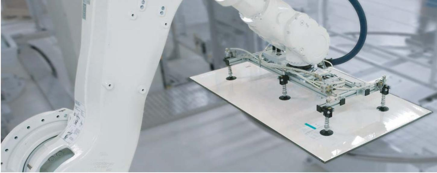
太阳能行业 | 蜘蛛手式真空端拾器 SSP 搬运太阳能电池板组件
