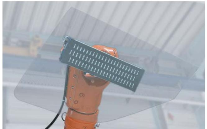
大面积真空吸具系统 FXP 装配汽车玻璃
