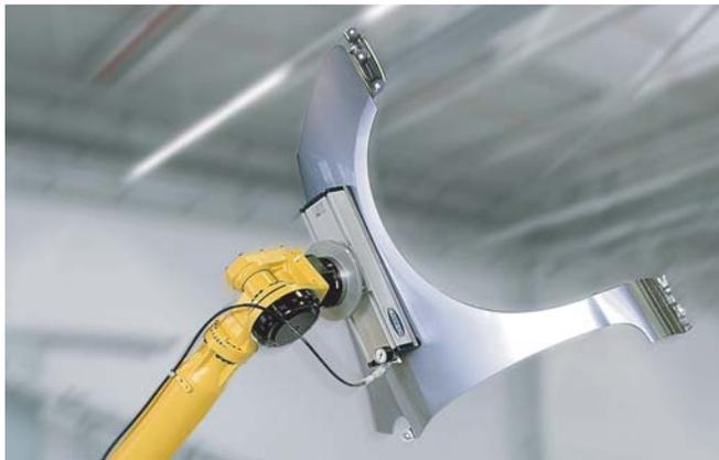
焊装车间使用大面积真空吸具系统 FXP 搬运车身部件
