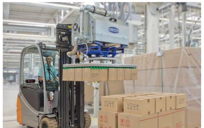
搭载在叉车上的整层搬运式真空吸具系统 SPZ 搬运纸箱
