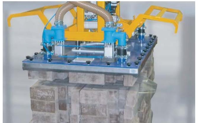
建筑材料 | 整层搬运式真空吸具系统 SPZ 配夹紧机械手搬运砖块和托架
