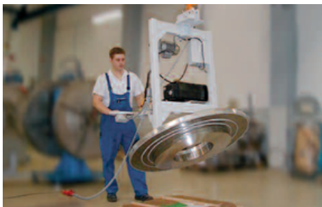
翻轉單元由線性電缸驅動。自動上鎖裝置任意固定工件在任何角度。
