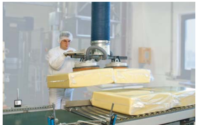
JumboSprint 負載 65 kg, 不銹鋼材質, 用於食品行業, 搬運整塊芝士
