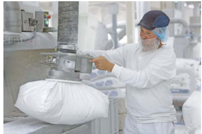
JumboSprint 負載65 kg, 用於防爆領域搬運袋裝類工件, 符合ATEX標準
