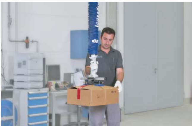
JumboFlex 負載 35 kg, 雙吸盤, 用於手動包裹, 倉儲和分揀設備的上料
