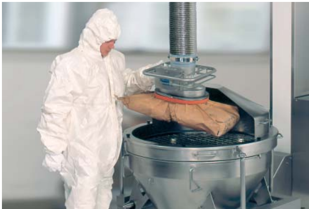
JumboSprint, 負載65kg,配有袋裝工件吸盤,用於防爆區域搬運袋類包裝工件,符合ATEX標準
