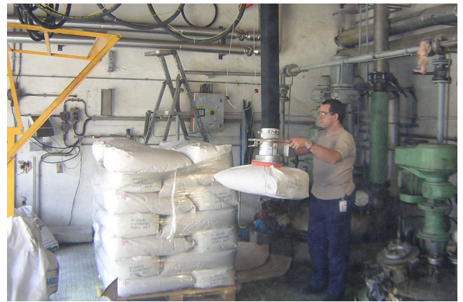
JumboSprint 負載65kg, 用於防爆領域進行碼垛, 符合ATEX標準
